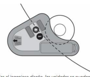
Gracias al ingenioso diseño, las unidades se pueden montar en poleas grandes y pequeñas.
